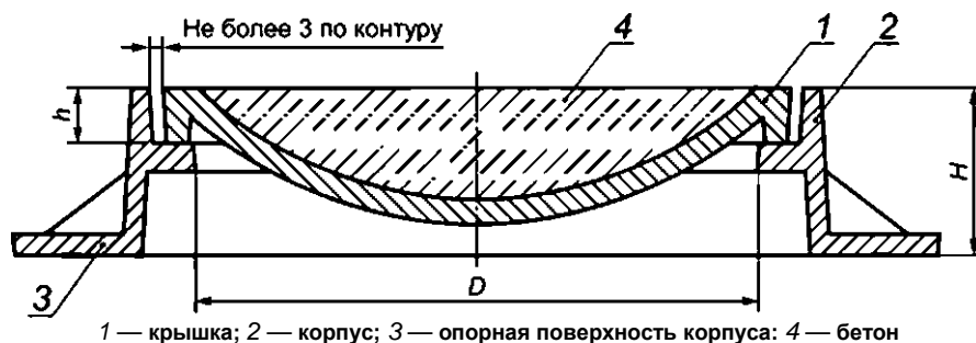
Рисунок А.3 — Люк с крышкой, имеющей углубление под заполнение бетоном
